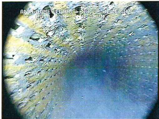
Colonne d'eau « centrale » chargée en turbidité avec venues d'eau claire depuis l'ensemble de la crépine
