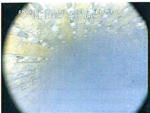
Colonne d'eau « centrale » chargée en turbidité avec venues d'eau claire depuis l'ensemble de la crépine, avec particules de craie en suspension
