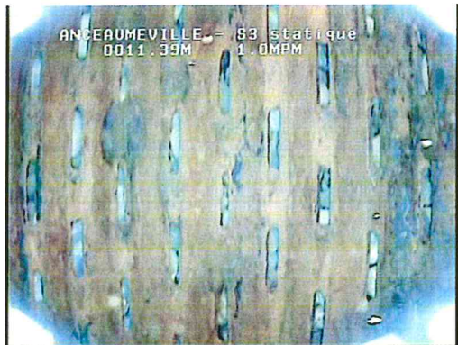
Incrustation hétérogène (zones de la crépine « intègres ») d'hydroxyde de fer avec adhérences de colloïdes (flocs bactériens). Fentes dégagées laissant entrevoir à l'extrados le massif de gravier filtre homogène et « intègre »
