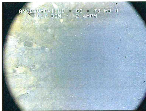
Colonne d'eau « centrale » chargée en turbidité avec venues d'eau claire depuis l'ensemble de la crépine, avec particules de craie en suspension
