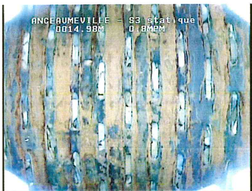
Incrustation hétérogène (zones de la crépine « intègres ») d'hydroxyde de fer avec adhérences de colloïdes (flocs bactériens). Fentes dégagées laissant entrevoir à l'extrados le massif de gravier filtre homogène et « intègre »
