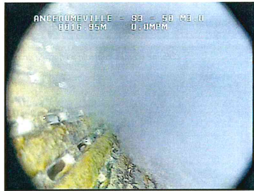
Colonne d'eau « centrale » chargée en turbidité avec venues d'eau claire depuis l'ensemble de la crépine
